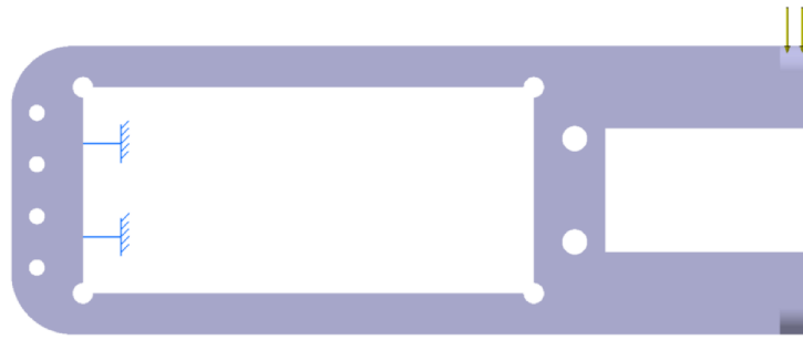
Figura 4.27: Definição das condições impostas: suporte servomotor braço.
